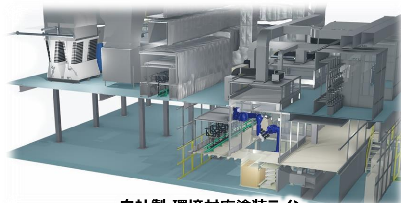
自社製 環境対応塗装ライン (オール電化塗装ライン)
