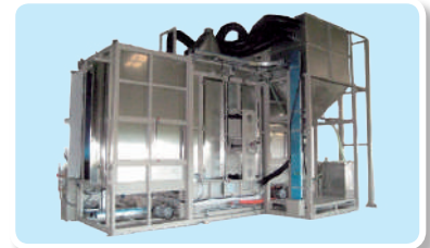
塗装システム (電界流動粉体静電装置)
